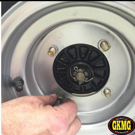
129. Use the (4) 10mm flange nuts per wheel.
